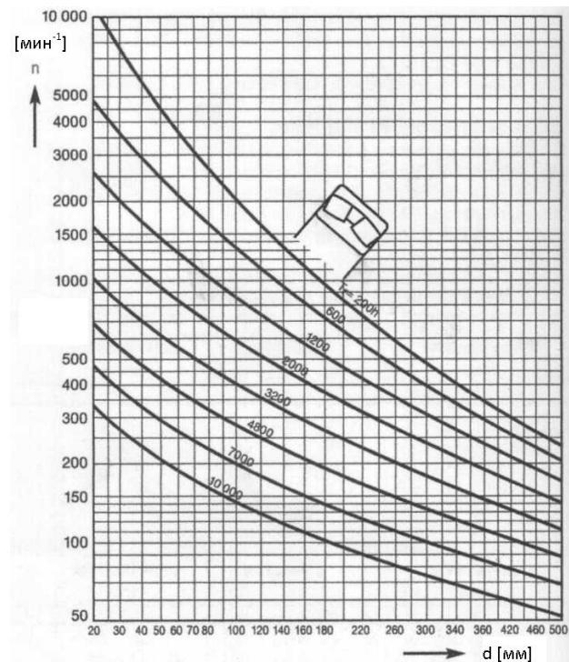
Если рабочая температура превышает 70 °C, интервал повторной смазки  $T_f$  может быть сокращен на половину для каждого 150°C выше уровня 70 °C. При рабочей температуре ниже 40 °C интервал повторной смазки можно удвоить. Если подшипник расположен на вертикальном валу, интервал повторной смазки, указанный в диаграмме, можно сократить в два раза.
