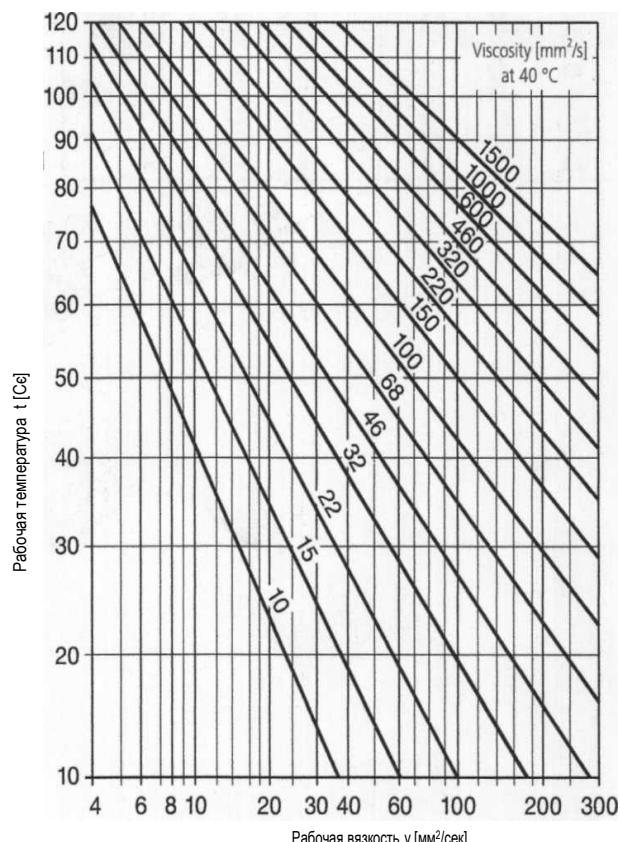
Номинальная вязкость  $\nu$ , определяется из нижеприведенной диаграммы при помощи среднего диаметра подшипника  $(D+d)/2$  [мм] и рабочей скорости  $n$  подшипника.
